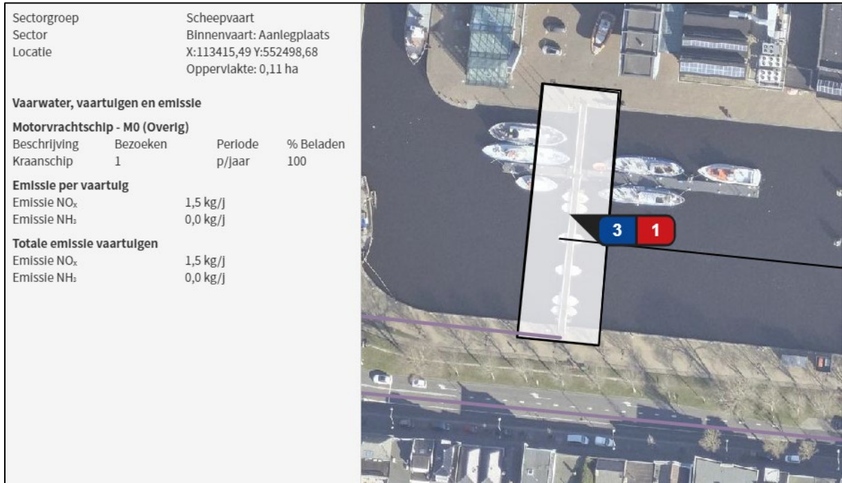
Figuur 6 / Ingevoerde emissies machine vanaf het water in de aanlegfase
