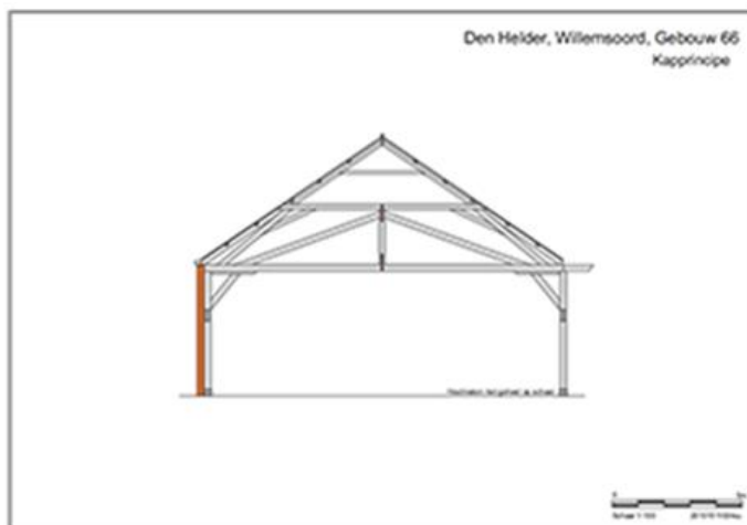
48 Kappincipe spant in combinatie met een hangwerk (rs)
