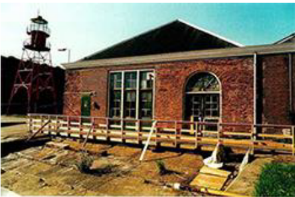
19 Linkerzijde zuidgevel voor restauratie 1997. De driedelige deur die oorspronkelijk geheel demontabel waardoor de opening in één keer geopend kon worden, dateert van na 1943. De stalen deur uiterst links behoort tot een trafo. (herkomst foto [redacted] en [redacted], 1997)
