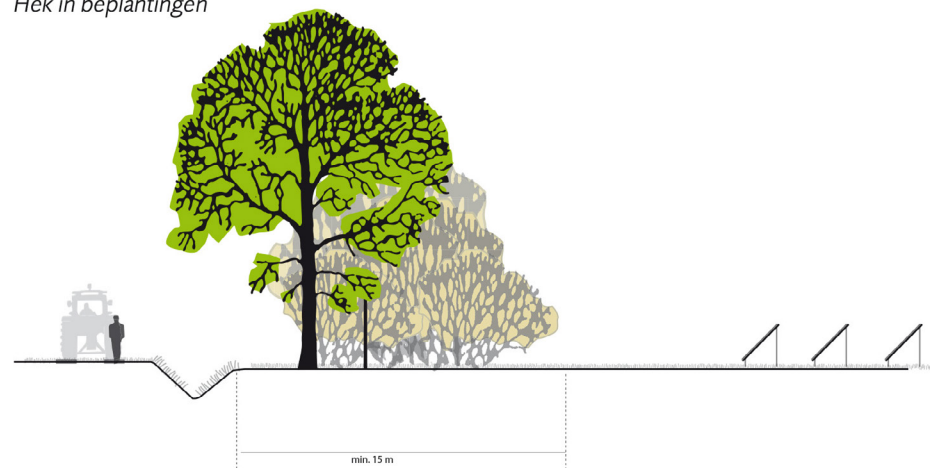
Mogelijkheden voor een landschappelijke inpassing van de randen van een zonnepark (bron: Van Paridon X de Groot landschapsarchitecten)
